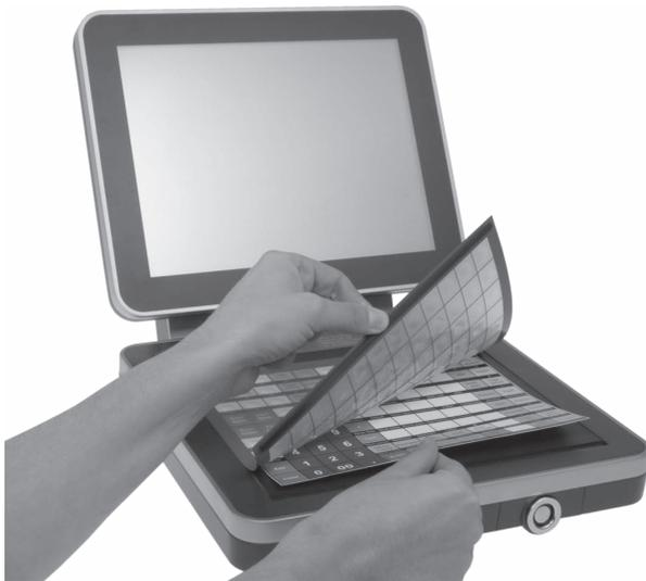
Abb. 13: Tastaturfolie anheben und Einlegeblatt ausrichten
