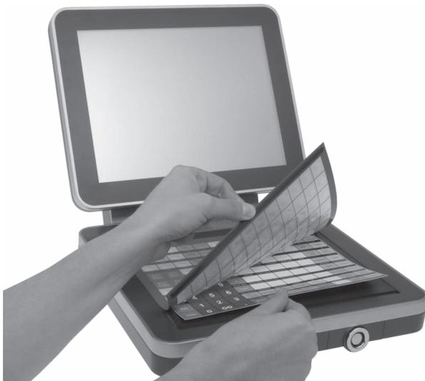
Abb. 25: Tastaturfolie anheben und Einlegeblatt ausrichten
