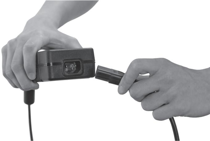
Abb. 12: Netzkabelstecker in Netzkabelbuchse stecken
