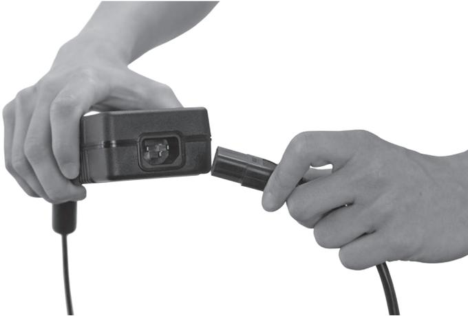
Abb. 24: Netzkabelstecker aus Netzkabelbuchse ziehen
