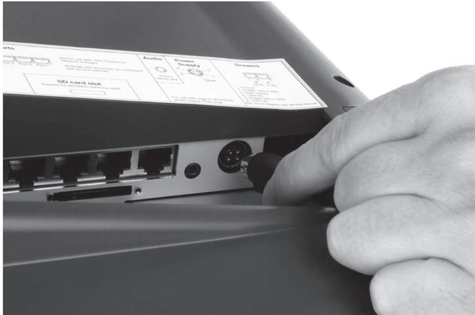
Abb. 23: Stromleitungsstecker aus Stromanschluss ziehen
